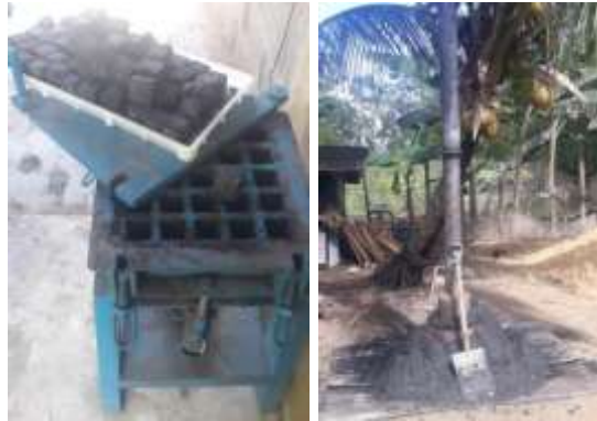
Gambar 11. Alat press briket arang sekam tipe semi hidrolik vertikal (kiri), dan alat pembuat arang sekam type chimney (kanan)
